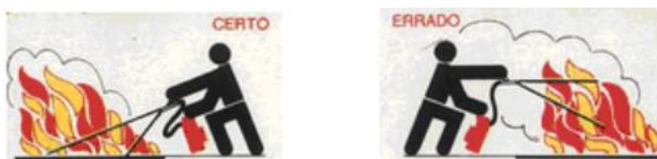
Figura 4 – Direcionamento correto do jato (base da chama)
