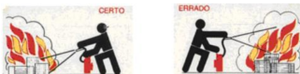
Figura 3 – Posicionamento correto do extintor (contra o vento)
