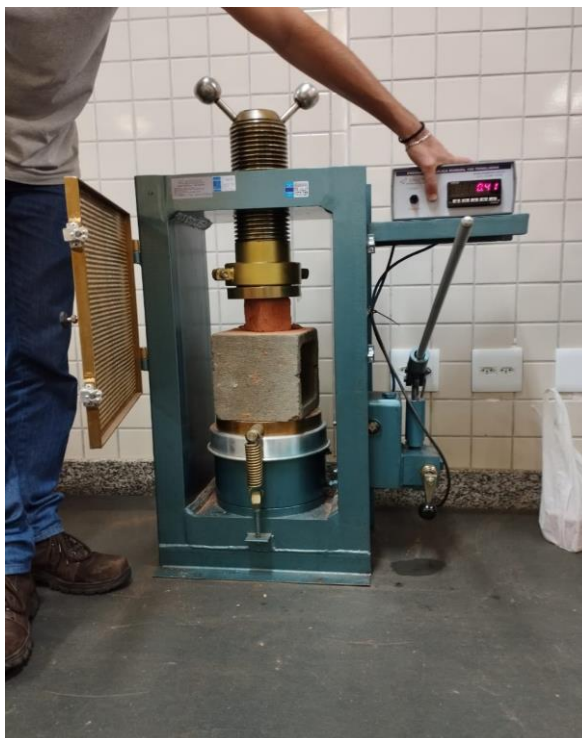
Figura 37 - Rompimento feito e registrado a carga máxima Fonte: Arquivo pessoal
