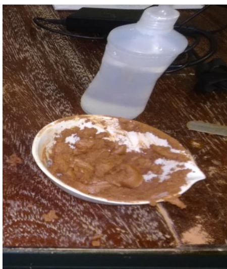
Figura 22 - Mistura homogênea do material com água destilada Fonte: Arquivo pessoal
