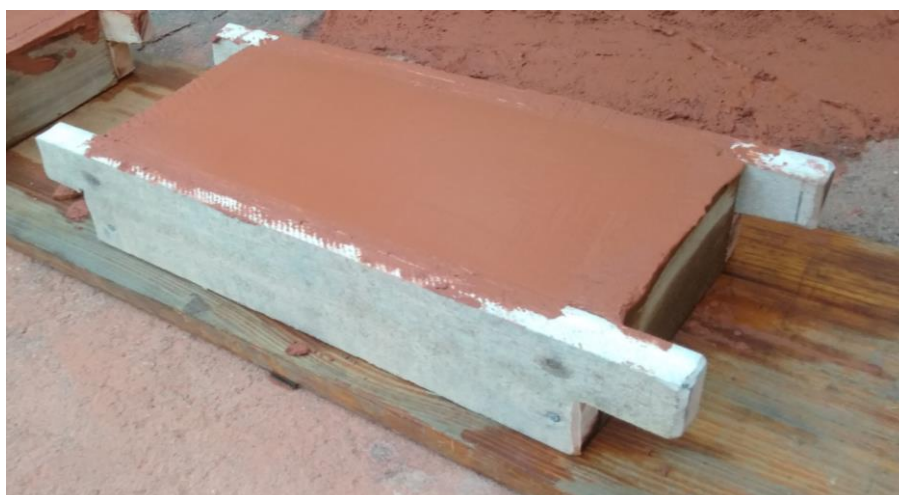
Figura 31 - Tijolo após moldagem e acabamento superficial Fonte: Arquivo pessoal
