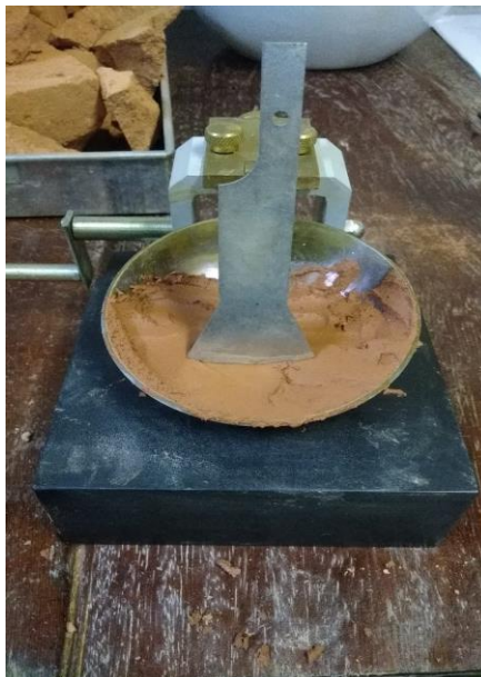
Figura 23 - Conferência da espessura da massa de solo com auxílio do cinzel Fonte: Arquivo pessoal
