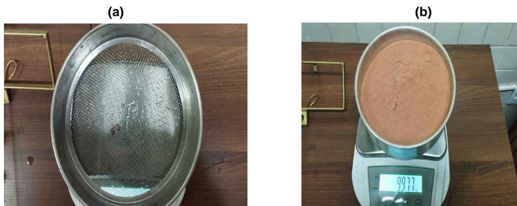
Figura 14 - (a) Peneira de 2,00 mm; (b) Material passante na peneira de 2,00 mm. Fonte: Arquivo pessoal
