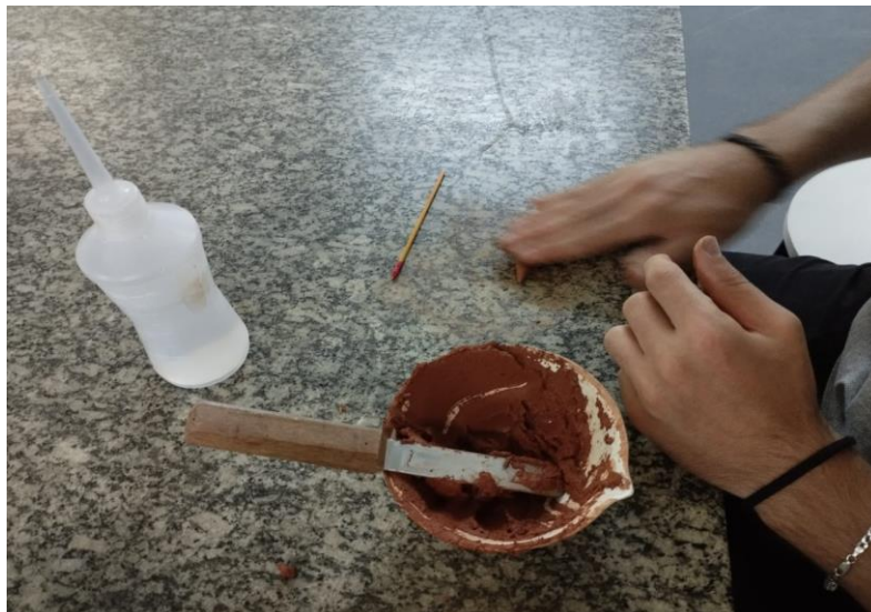
Figura 27 - Execução ensaio de Limite de Plasticidade Fonte: Arquivo pessoal
