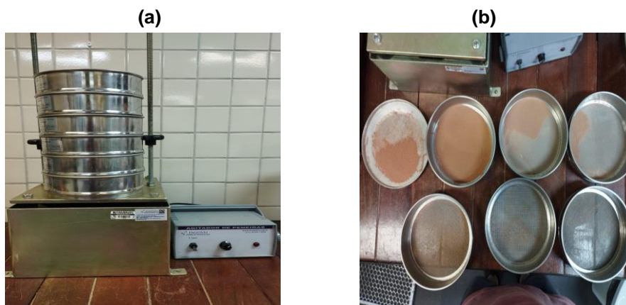
Figura 17 - (a) Montagem das peneiras no agitador mecânico; (b) Material retidos nas peneiras Fonte: Arquivo pessoal
