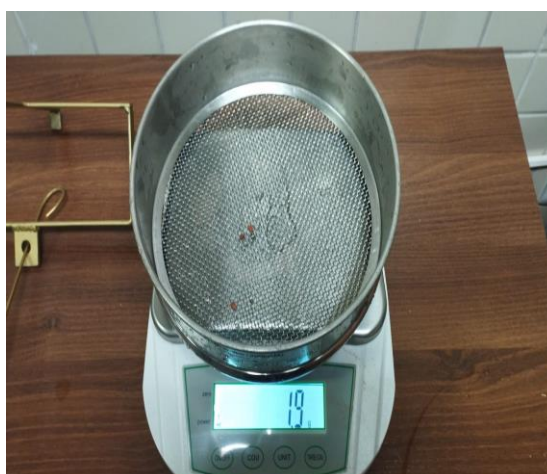
Figura 15 - Material retido na peneira de 2,00 mm Fonte: Arquivo pessoal
