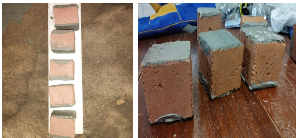
Figura 34 - Capeamento realizado com pasta de cimento nos corpos de prova Fonte: Arquivo pessoal
