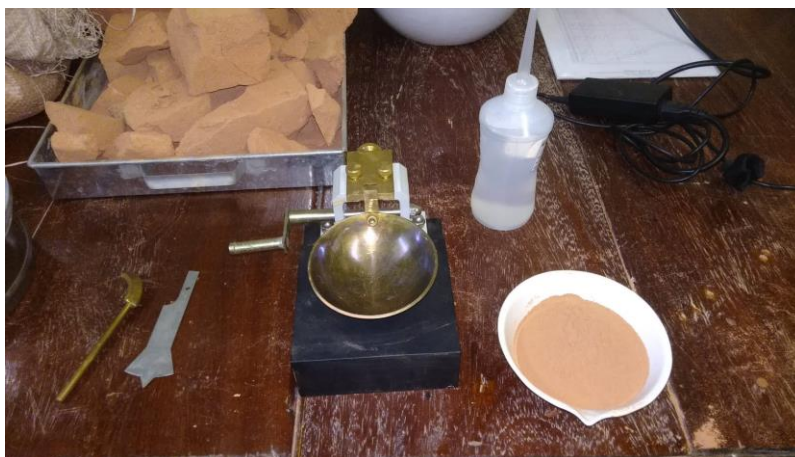
Figura 20 - Material utilizado no ensaio de determinação do limite de liquidez Fonte: Arquivo pessoal
