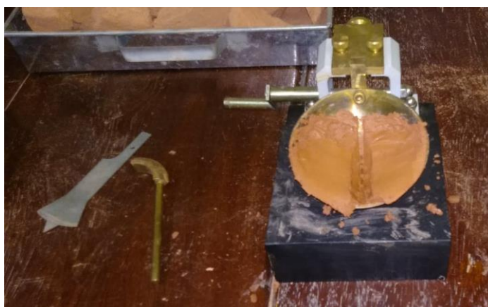
Figura 24 - Divisão da massa de solo em duas partes Fonte: Arquivo pessoal
