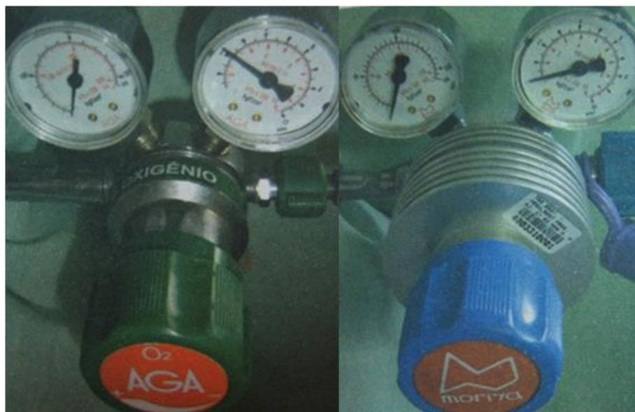
**Figura 2 - Válvulas reguladoras de pressão**
