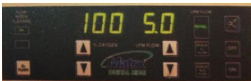
**Figura 5 - Válvula de controle de fluxo ajuste digital**
