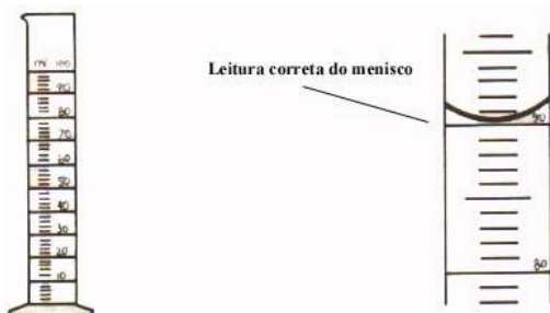
Figura 1. Procedimento correto de como se realizar a leitura do menisco em uma proveta (para líquidos incolores).
