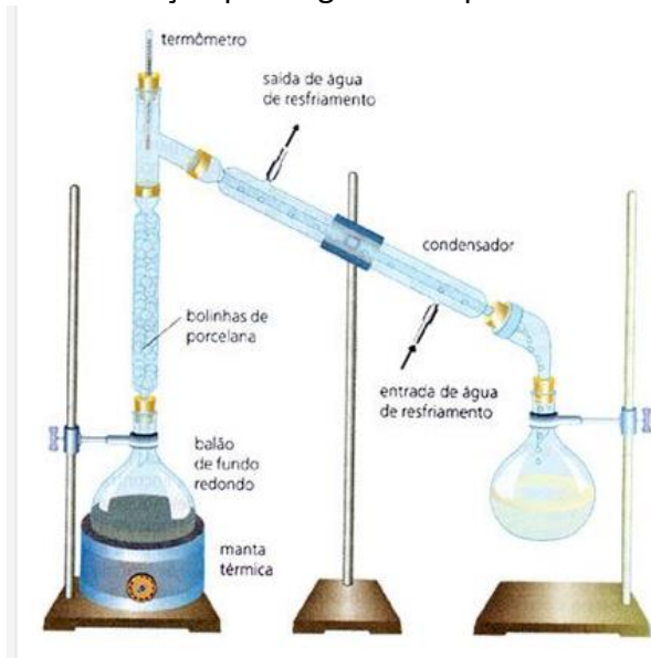
Figura 2- Esquema de um processo de destilação fracionada.
