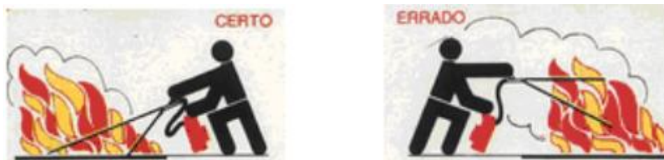
Figura 4 – Direcionamento correto do jato (base da chama)
