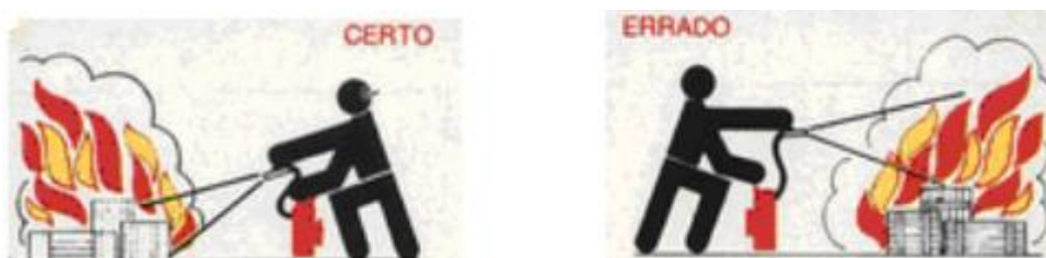
Figura 3 – Posicionamento correto do extintor (contra o vento)
