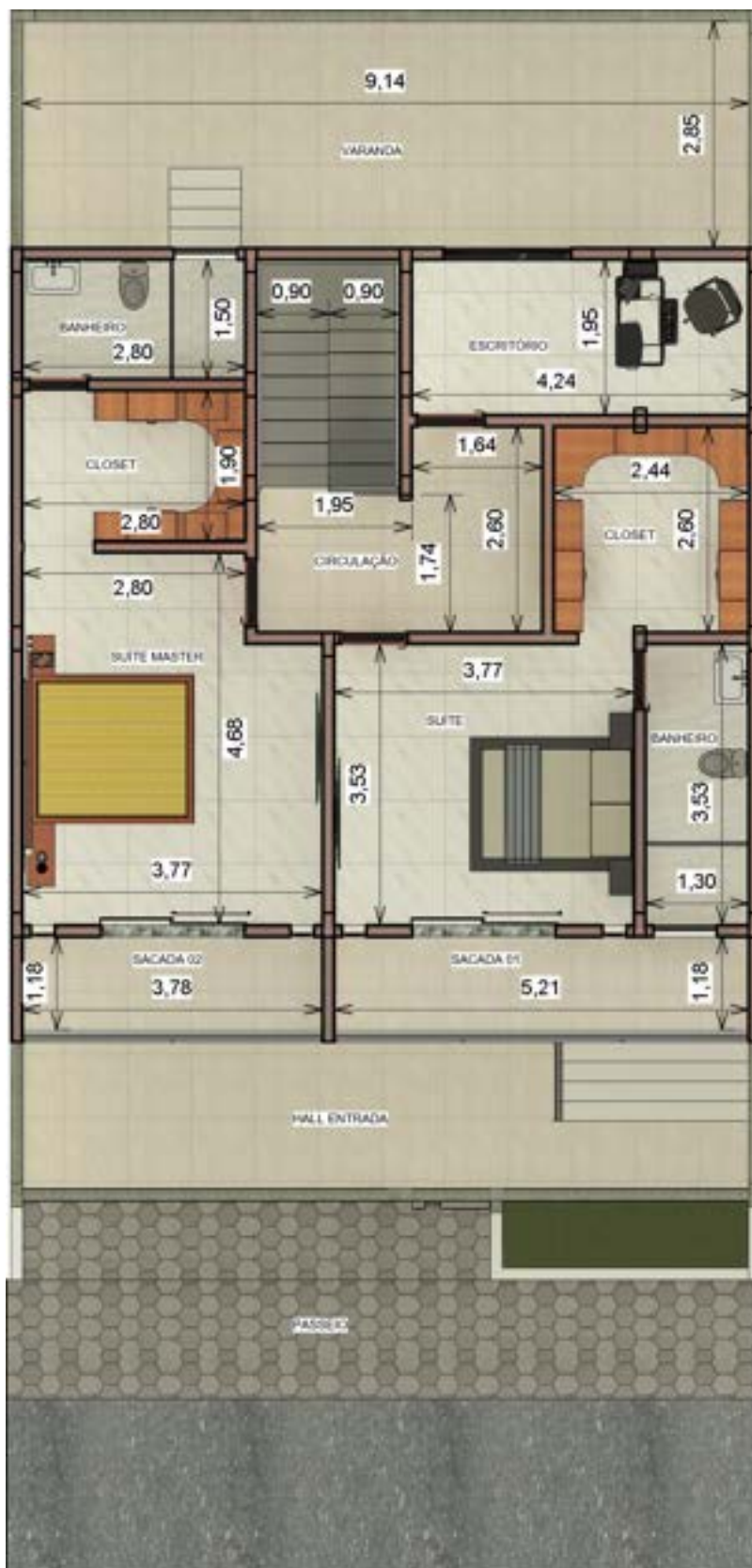
Figura 21 – Planta Baixa Humanizada – 1º pavimento
