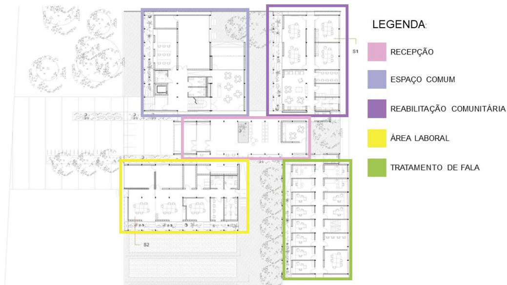
Figura 11 – Planta setorizada, pavimento térreo. Centro médico.
