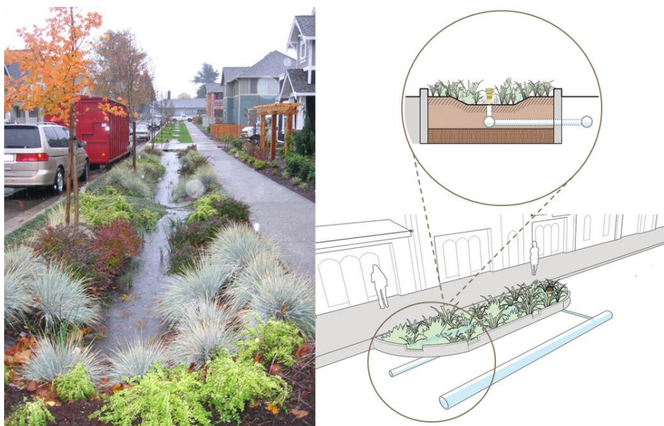
Figura 6- Bioswale em Seattle, Washington e desenho esquemático
