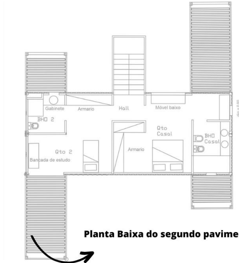
Figura 16 – Planta Baixa Casa Contêiner, Container Box
