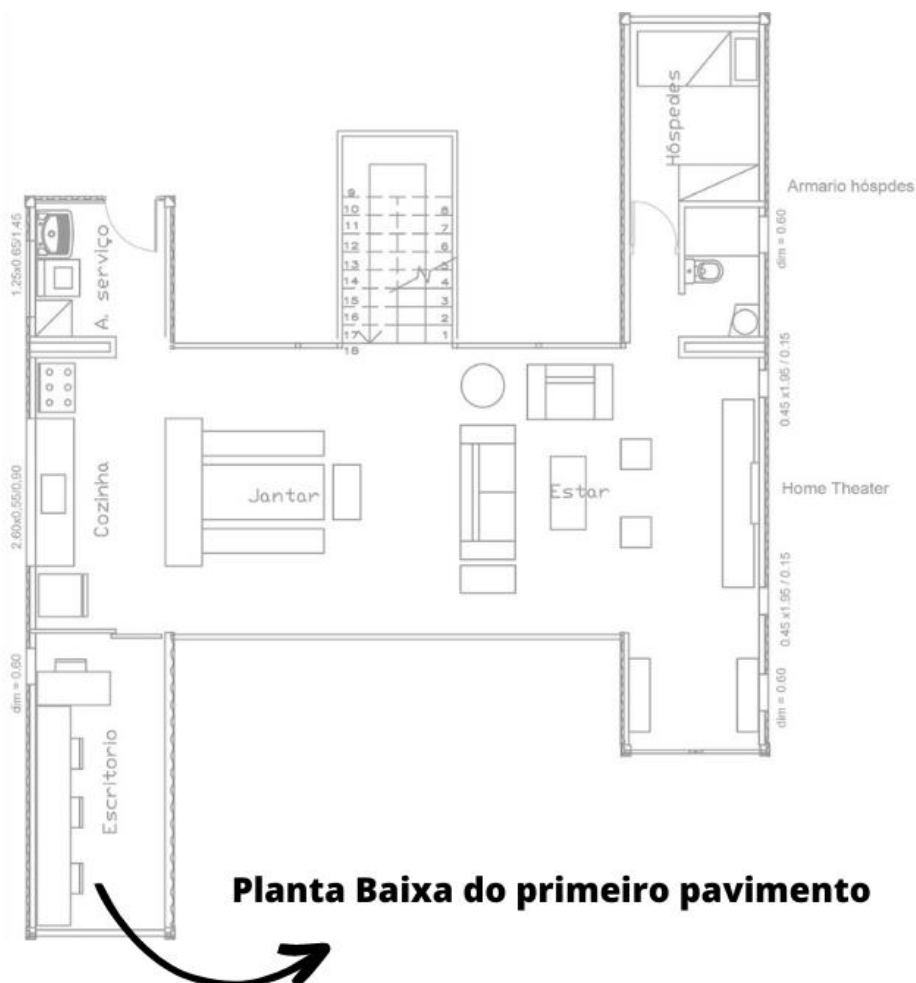
Figura 15 – Planta Baixa Casa Contêiner, Container Box
