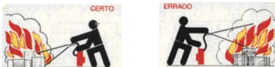
Figura 3 – Posicionamento correto do extintor (contra o vento)
