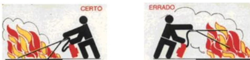
Figura 4 – Direcionamento correto do jato (base da chama)
