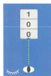
Figura 4 - Alinhamento correto do visor da pipeta automática
